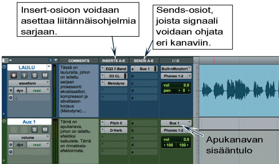
Kuva 2. Apukanavan käyttö rinnankytkennässä. Kuva: Jari Eerola.
