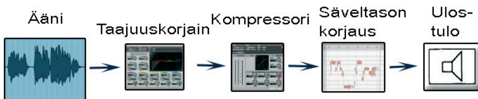
Kuva 1. Sarjaankytkentä. Kuva: Jari Eerola.
