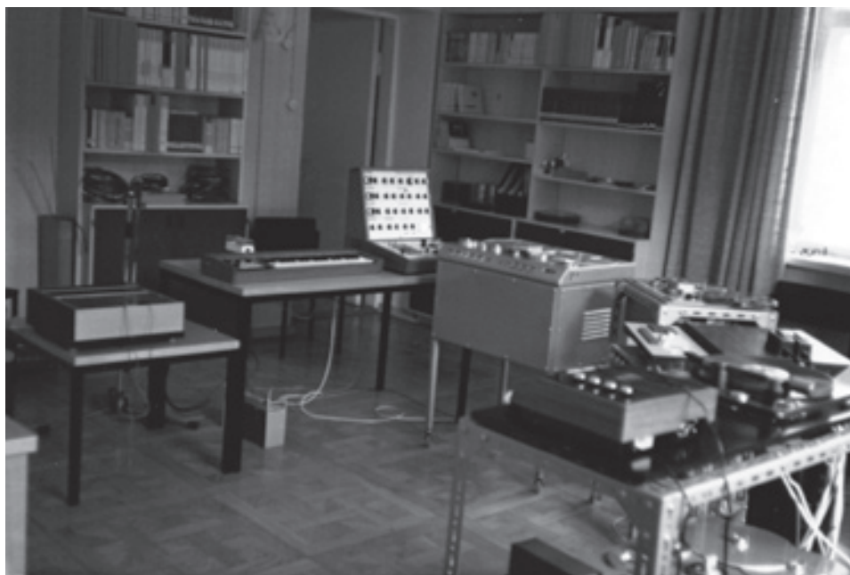
Kuva 2. Yliopiston elektronimusiikkistudio vuosina 1973–74. Kuvassa näkyvä studiolaitteisto vasemmalta oikealle: Kurenniemen rakentama DIMI-A (1970) matalalla pöydällä, tämän vieressä VCS3-syntetisaattori koskettimistoineen, Studer C37 -kelanauhuri, Studer A62 -kelanauhuri, Kurenniemen rakentama digitaalinen ristikytkentäpöytä ja mikseri DIMIX (1972) sekä edessä oikealla EMT-levysoitin ja C-kasettisoitin. (Kuva: Kansallisgalleria, Erkki Kurenniemen arkisto.)
